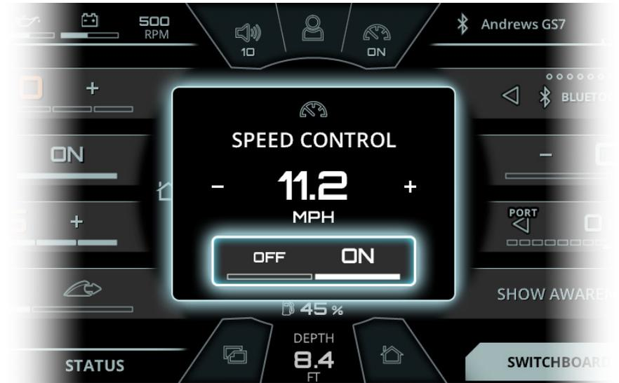
FIG. B5 - POP-UP AFTER PRESSING THE SPEED CONTROL BUTTON ON HELM COMMAND
