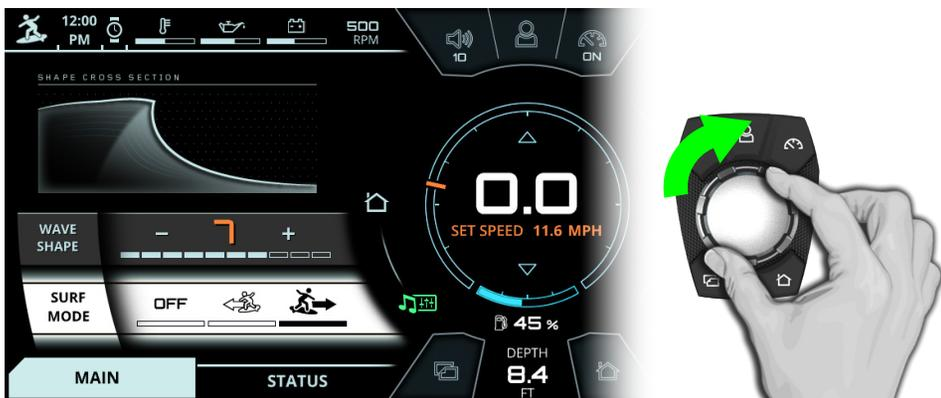
FIG. A9 - ROTATING CLOCKWISE TO CHANGE SURF WAVE TO THE STARBOARD SIDE
